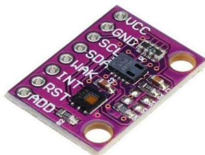
Figura 2.2.- Sensor de gases CCS811.
