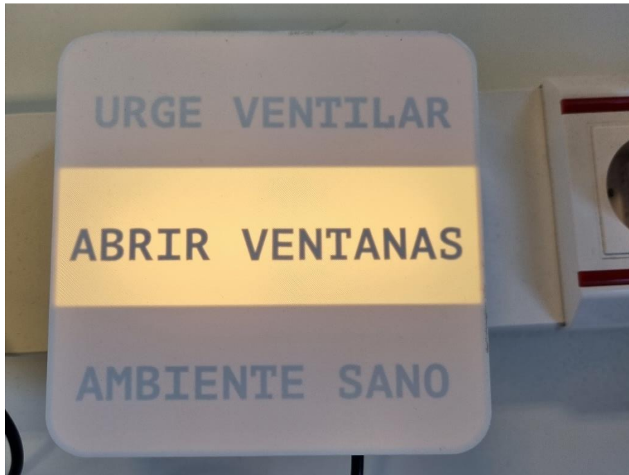
Figura 3.16.- Visualización del sensor mostrando el color ámbar y sugiriendo abrir ventanas.
