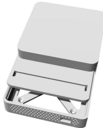
Figura 3.10.- Conjunto bastidor, soporte y difusor.
