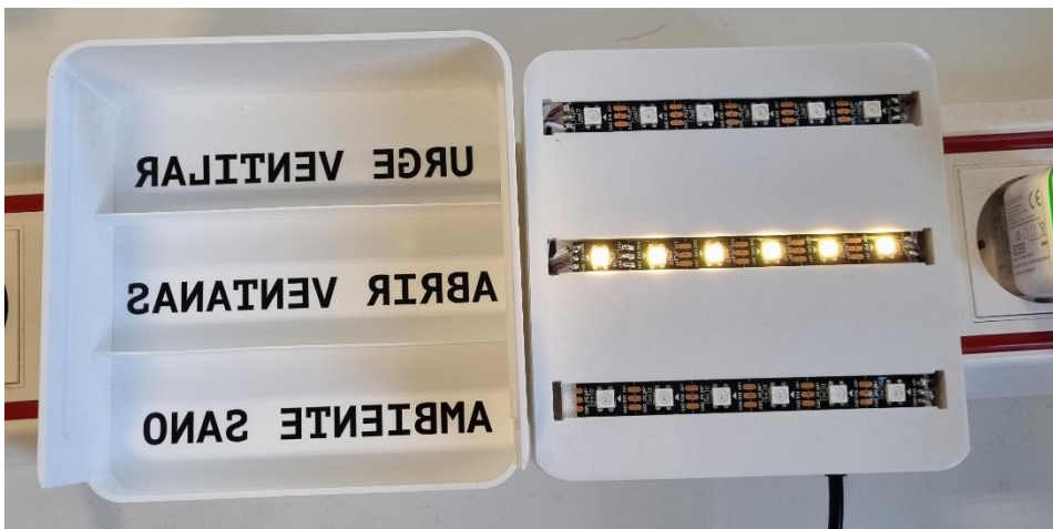
Figura 3.19.- Visualización del texto y los LEDs en color ámbar.
