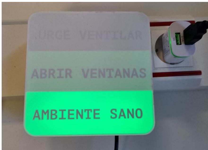
Figura 3.15.- Visualización del sensor mostrando el color verde decretando un ambiente sano.
