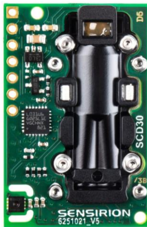
Figura 3.1.- Sensor CO 2 Sensirion SCD30.
